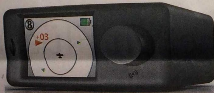
Hallo Nachbar: Neuere Displays zeigen mehrere Luftfahrzeuge an und extrahieren die Steigwerte der Segler in der Nähe.
